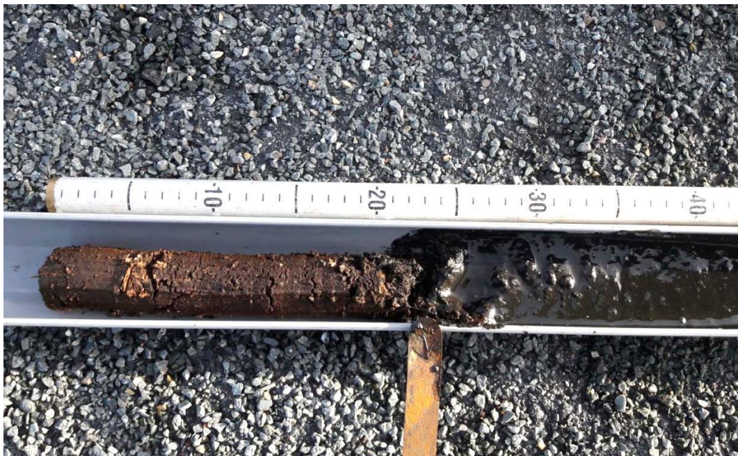
Afbeelding 5. Verificatiemeting onderzijde sedimentlaag / overgang naar vaste bodem
